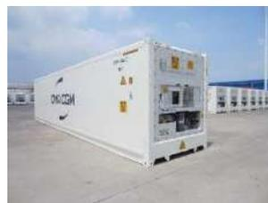
Les reefers sont des conteneurs frigorifiques, spécialisés pour le transport des denrées et produits périssables, nécessitant de l'énergie et des gaz réfrigérants. Les
